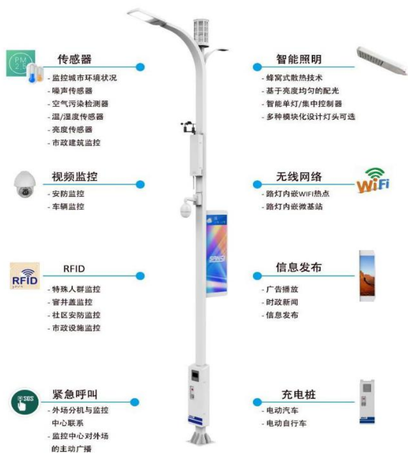
图 8.4-6 智慧路灯充电系统示意图
