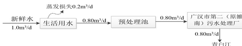
图 2-5 项目水平衡图 (单位 m<sup>3</sup>/d)
